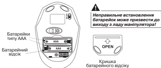
Мал. 4. Встановлення батарейок
