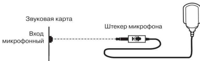
Рис. 1. Схема подключения
