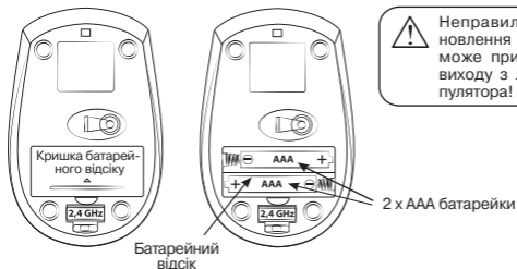
Мал. 4. Встановлення батарейок
