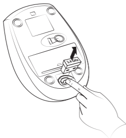
Рис. 5. Извлечение ресивера из корпуса мыши
