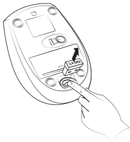
Мал. 5. Виймання ресивера з корпусу миші
