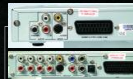
Порты подключения DVD-плеера — от минимализма до полного набора аудио- и видеовыходов
