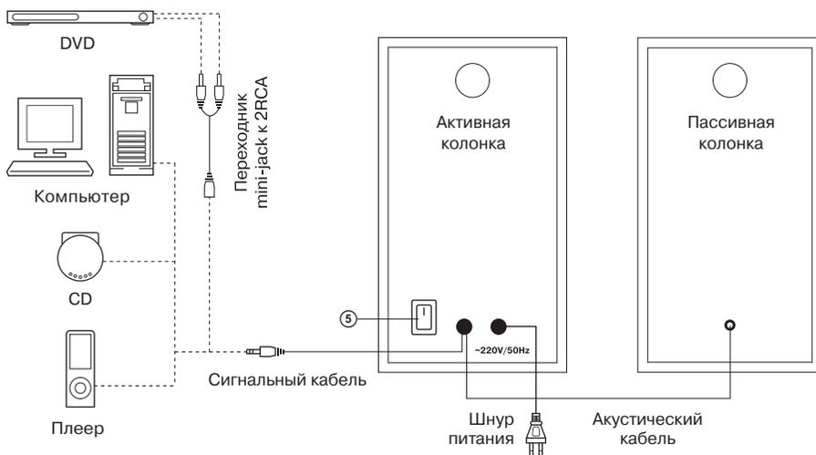
Рис. 2. Схема подключения
