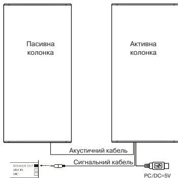
Мал. 2. Схема підключення
