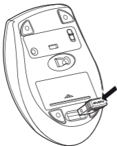
Мал. 6. Встановлення ресивера в корпус миші
