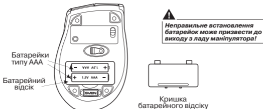
Мал. 4. Встановлення батарейок
