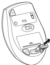
Мал. 7. Виймання ресивера з корпусу миші
