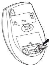
Рис. 7. Извлечение ресивера из корпуса мыши
