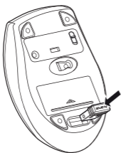
Рис. 6. Установка ресивера в корпус мыши
