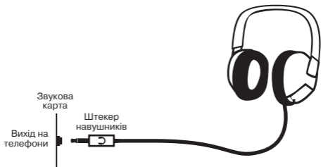
Мал. 1. Схема підключення
