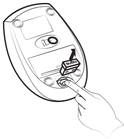
Мал. 5. Виймання ресивера з корпусу миші
