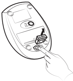
Рис. 5. Извлечение ресивера из корпуса мыши
