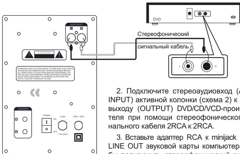
Схема 2. Подключение колонок к источнику аудиосигнала
