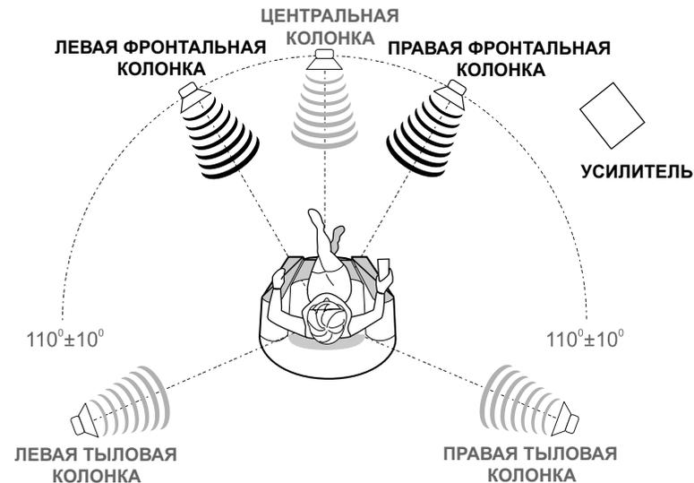
Для получения наилучшего результата при прослушивании расстояние между головой слушателя и каждой из колонок должно быть одинаковым и примерно равно расстоянию между колонками. Разместите фронтальные АС справа и слева от позиции прослушивания. Высокочастотные динамики фронтальных акустических систем должны находиться на уровне уха слушателя. Оси фронтальных акустических систем должны пересекаться перед лицом слушателя.
